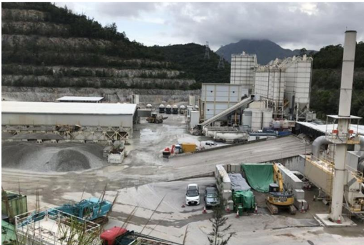
現時石礦場的一站式的營運，把混凝土廠、選青廠等設於石礦場內。政府圖片
